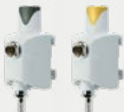
Morsetto per barra 30x10 mm e 50x10 mm in tecnopolimero completo di distanziale filettato ISO G. 1/4" F. e portagomma Ø 6 mm (gas medicali) oppure Ø 7,5 mm (aspirazione).
