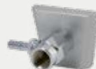
Cuneo in alluminio anodizzato per scorrevole OHMEDA completo di distanziale filettato ISO G. 1/4" F. e portagomma Ø 6 mm (gas medicali) oppure Ø 7,5 mm (aspirazione).
